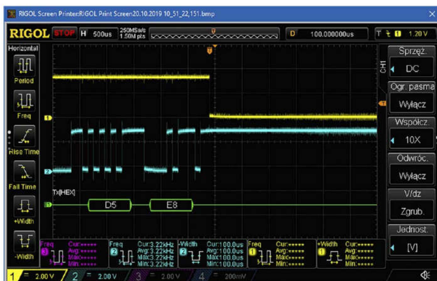
Rysunek 2. Kierunek transmisji RS485 jest zmieniany po wystaniu znaku, co pokazuje oscylogram
