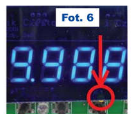
Przelotki zakryć maska lutownicza Rys. 15
