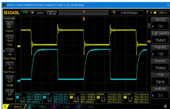
Rysunek 5. Pomiary oscyloskopowe toru wejściowego dla częstotliwości 1 MHz
